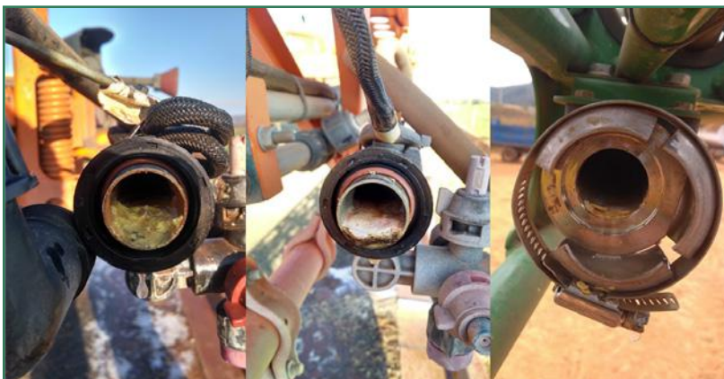
Figura 11. Tubulação de pulverizador com resíduos de defensivos agrícolas
