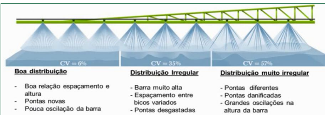
Figura 2. Avaliação da variação na vazão das pontas de pulverização.
