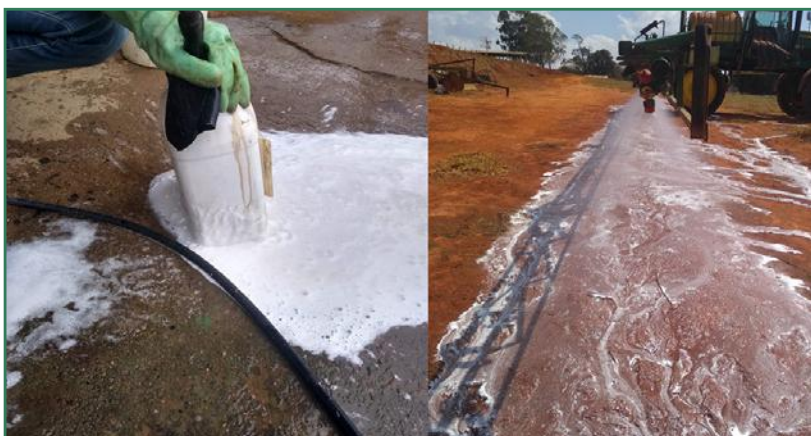
Figura 13. Limpeza das pontas de pulverização e peneiras (esquerda) e limpeza do sistema de pulverização (direita).
